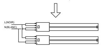
Refaites le câblage du luminaire en fonction de la configuration du câblage.
