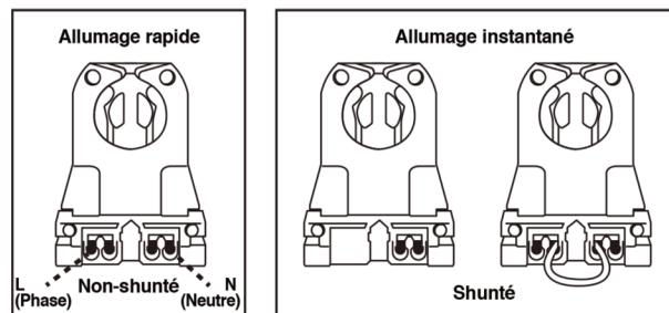
Figure 1. - Support de lampe non-dérivé et dérivé
