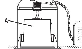
**5a** Enchufe el conector del cable en el adaptador de enchufe en el dispositivo.
