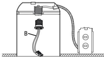
**4a** Instalación en una lata empotrada: Atornille el adaptador de enchufe de base mediana (E26) en el enchufe de la lata.
