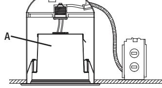
**6a** Insérez le luminaire dans la boîte. Rétablir le courant au coffret électrique.
