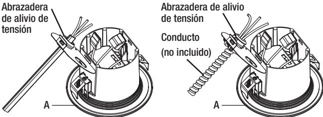
**4b** Pase los cables según el código eléctrico local a través de la abrazadera de alivio de tensión y realice las conexiones eléctricas. Inserte los cables neutrales calientes de la fuente eléctrica en los conectores de cables de los cables blanco y negro en la caja eléctrica.
