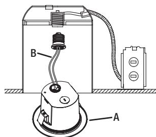
**5a** Branchez le connecteur du câble sur l'adaptateur de prise dans le luminaire.
