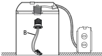
**4a** Installation dans une boîte encastrée : Vissez l'adaptateur de douille à base moyenne (E26) dans la douille de la boîte.
