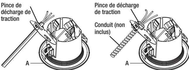
**4b** Faites passer les fils conformément au code électrique local à travers la pince de décharge de traction et effectuez les connexions électriques. Insérez les fils chauds et neutres de la source électrique dans les connecteurs de fils des fils noir et blanc dans la boîte électrique.
