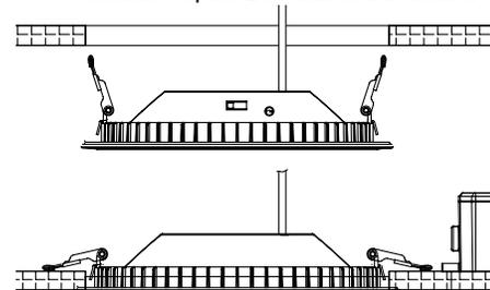
**10** Comprimez les pinces à ressort et introduisez le plafonnier à DEL dans l'ouverture dans le plafond.
