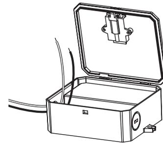
**7** Acheminez les fils conformément au code de l'électricité et passez-les dans la débouchure.
