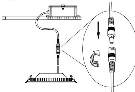
**9** Inserte la caja eléctrica en el orificio del techo. Conecte el conector de cable de la caja eléctrica al conector de cable de la lámpara.
