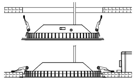
**10** Comprima los clips de resorte e inserte el downlight LED en el orificio del techo. Restaure la alimentación de la caja eléctrica. Encienda el interruptor de luz para activar la lámpara.
